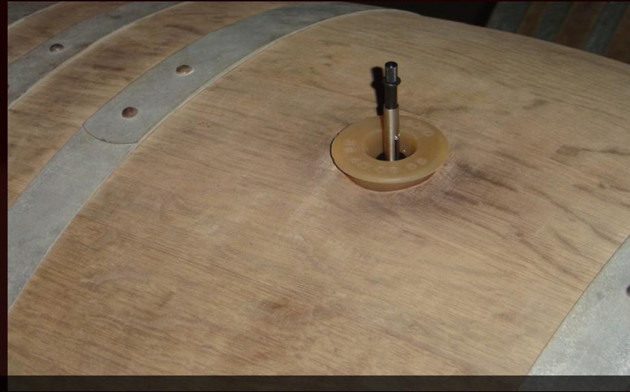
Toma de muestra - método SPME (Solid Phase Micro Extraction) - sin colector
