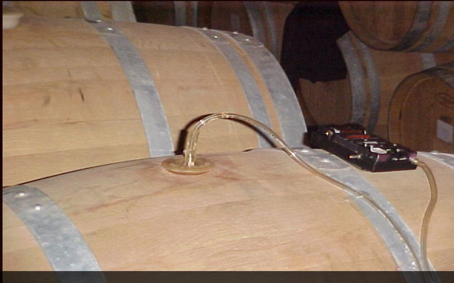
Recolección de muestras: método de purga y trampa (paso de aire a través del colector)
